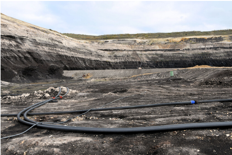
Tagebau Inden: fliegende Wasserhaltung auf der 4. Sohle, Überlaufbecken und HD-PE-Rohrleitungen; Foto: 09.11.2022 Fotograf/Urheber: Dr. Norbert Gilson
