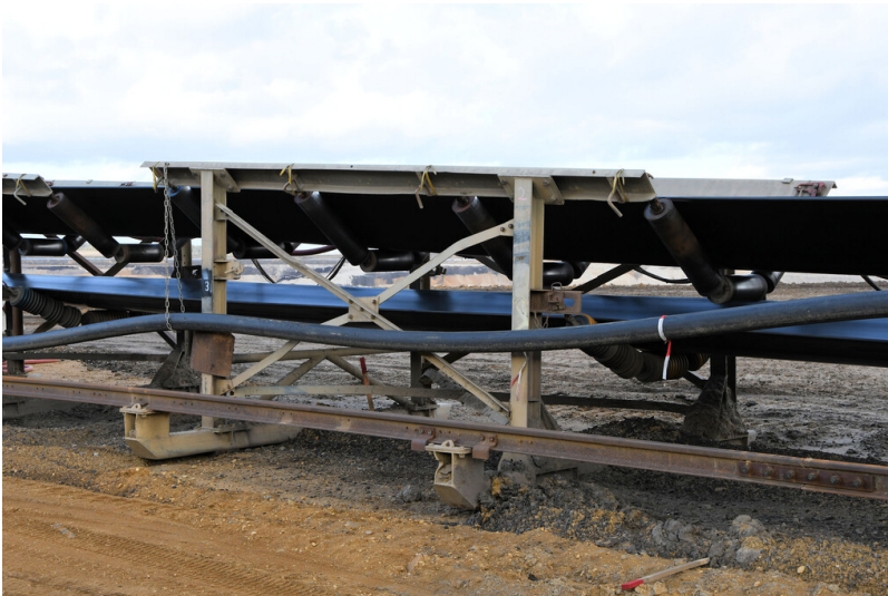
Tagebau Inden: Girlandenträgergest B 2200 mit starren Längsholmen zur Aufnahme der Tragrollen auf Gewinnungssohle 1 von Bagger 255 zum Bandsammelpunkt; Foto: 09.11.2022 Fotograf/Urheber: Dr. Norbert Gilson
