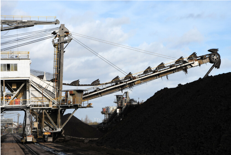
Tagebau Inden: Eimerketten-Tragarm und Seilstütze von Eimerkettenbagger 618 im Kohlebunker Inden, Ansicht von Süden; Foto: 09.11.2022 Fotograf/Urheber: Dr. Norbert Gilson
