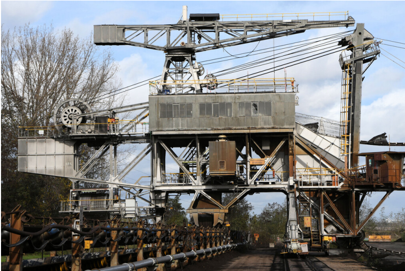
Tagebau Inden: Stahlfachwerkträgerkonstruktion von Eimerkettenbagger 617 mit Aufbauten auf portalartigem Schienenfahrwerk im Kohlebunker Inden, Ansicht von Süden; Foto: 09.11.2022 Fotograf/Urheber: Dr. Norbert Gilson
