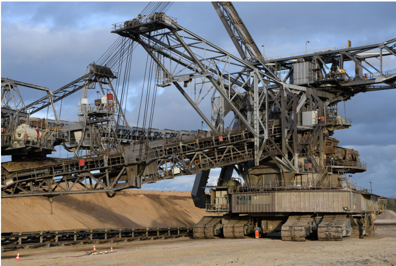
Tagebau Inden: Absetzer 754, Mittelbau mit Zubringerausleger und Aufhängung; Foto: 09.11.2022 Fotograf/Urheber: Dr. Norbert Gilson
