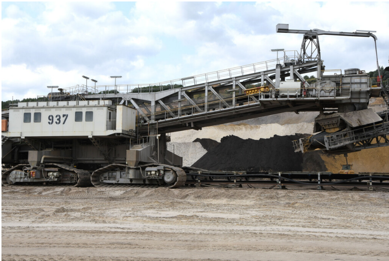
Tagebau Inden: Bandschleifenwagen 937, feststehender Übergabeausleger; Foto: 26.06.2023 Fotograf/Urheber: Dr. Norbert Gilson
