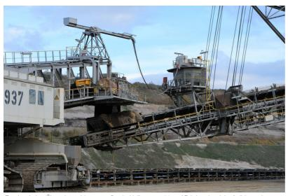
Tagebau Inden: Übergabevorrichtung von Bandschleifenwagen 937 auf Zubringerband des freihängenden Zubringerauslegers von Absetzer 753; Foto: 09.11.2022 Fotograf/Urheber: Dr. Norbert Gilson
