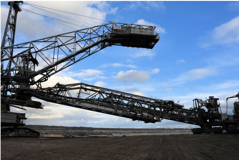
Tagebau Inden: Absetzer 741, auf Raupenwagen abgestützte Verbindungsbandbrücke als Zubringerausleger; Foto: 09.11.2022 Fotograf/Urheber: Dr. Norbert Gilson
