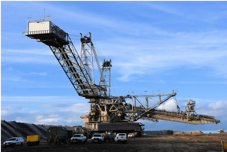
Tagebau Inden: Absetzer 737, Gegengewichtsausleger und Zubringerausleger; Foto: 09.11.2022 Fotograf/Urheber: Dr. Norbert Gilson
