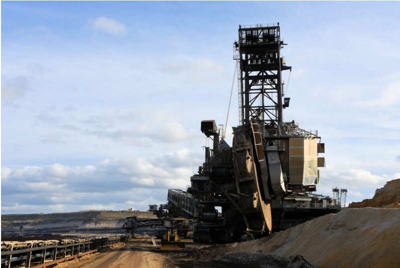
Tagebau Inden: Schaufelradbagger 286, Schaufelradaufhängung; Foto: 09.11.2022 Fotograf/Urheber: Dr. Norbert Gilson
