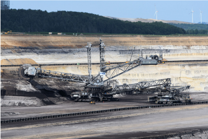
Tagebau Inden: Schaufelradbagger 282 bei der Abraumgewinnung, Ansicht von Nordosten (Tagebau-Aussichtspunkt Schophoven); Foto: 14.07.2023 Fotograf/Urheber: Dr. Norbert Gilson
