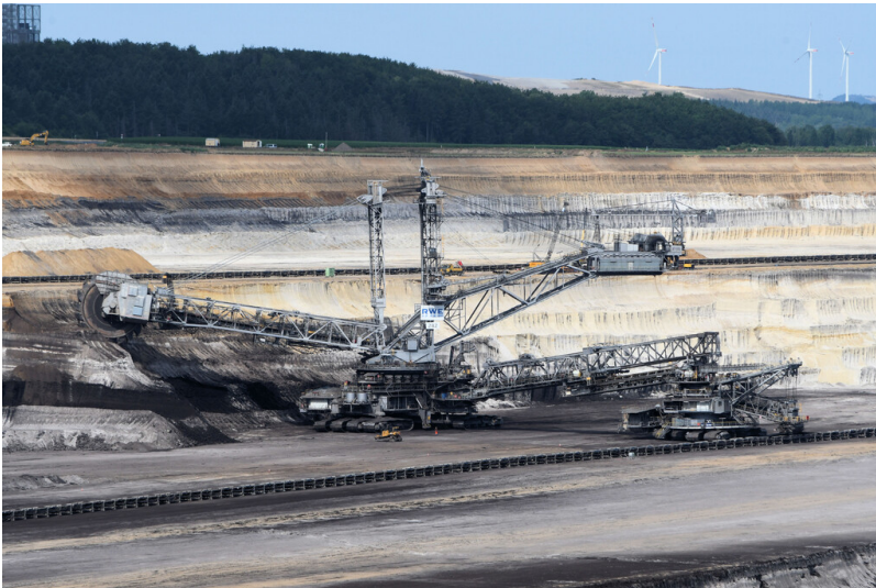
Tagebau Inden: Schaufelradbagger 282 bei der Abraumgewinnung, Ansicht von Nordosten (Tagebau-Aussichtspunkt Schophoven); Foto: 14.07.2023 Fotograf/Urheber: Dr. Norbert Gilson
