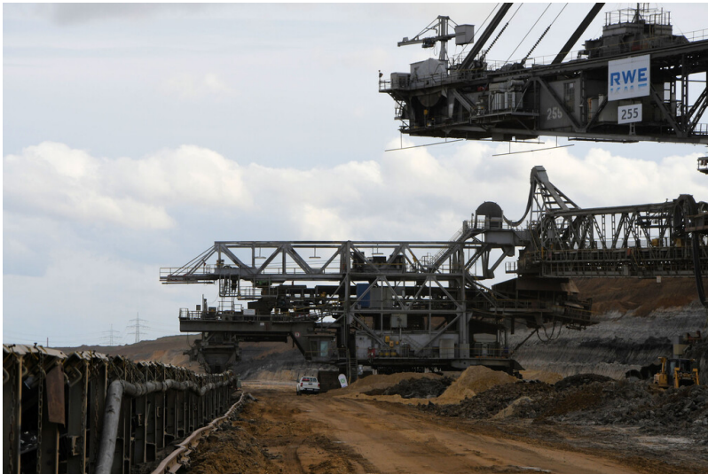
Tagebau Inden: Schaufelradbagger 255, Beladewagen; Foto: 09.11.2022
