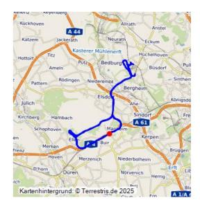
Die 21,5 Kilometer lange, zweigleisige und voll elektrifizierte Hambachbahn zwischen dem Gleisanschluss Hambachbahn am Tagebau Hambach im Westen und dem Anschluss an die Gleisanlagen der Nord-Süd-Bahn im Bereich der Ortslage Niederaußem im Osten wurde im Januar 1984 für den Transport der im Tagebau Hambach geförderten Rohkohle in Betrieb genommen.
