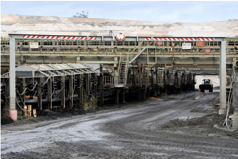
Tagebau Hambach: Fahrstraße unter den Verschiebeköpfen des Bandsammelpunkts, Ansicht von Süden; Foto: 07.11.2022 Fotograf/Urheber: Dr. Norbert Gilson
