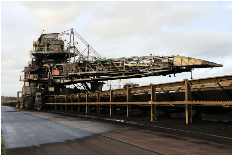
Tagebau Hambach: Bandschleifenwagen 992, Abwurfausleger; Foto: 07.11.2022 Fotograf/Urheber: -
