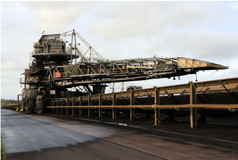
Tagebau Hambach: Bandschleifenwagen 992, Abwurfausleger; Foto: 07.11.2022 Fotograf/Urheber: -
