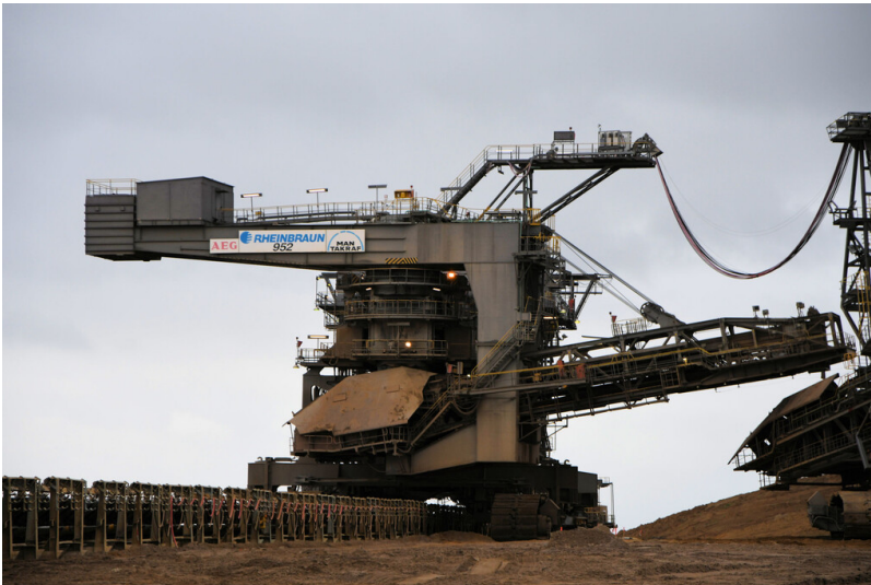
Tagebau Hambach: Bandschleifenwagen 952, Schwenkbandausleger; Foto: 07.11.2022 Fotograf/Urheber: Dr. Norbert Gilson
