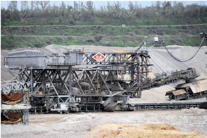
Tagebau Hambach: Bandschleifenwagen 948 mit Schwenkbandausleger; Foto: 07.11.2022 Fotograf/Urheber: Dr. Norbert Gilson
