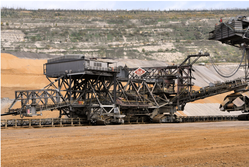
Tagebau Hambach: Bandschleifenwagen 949 mit Auflaufteil und Schwenkbandausleger; Foto: 07.11.2022 Fotograf/Urheber: Dr. Norbert Gilson
