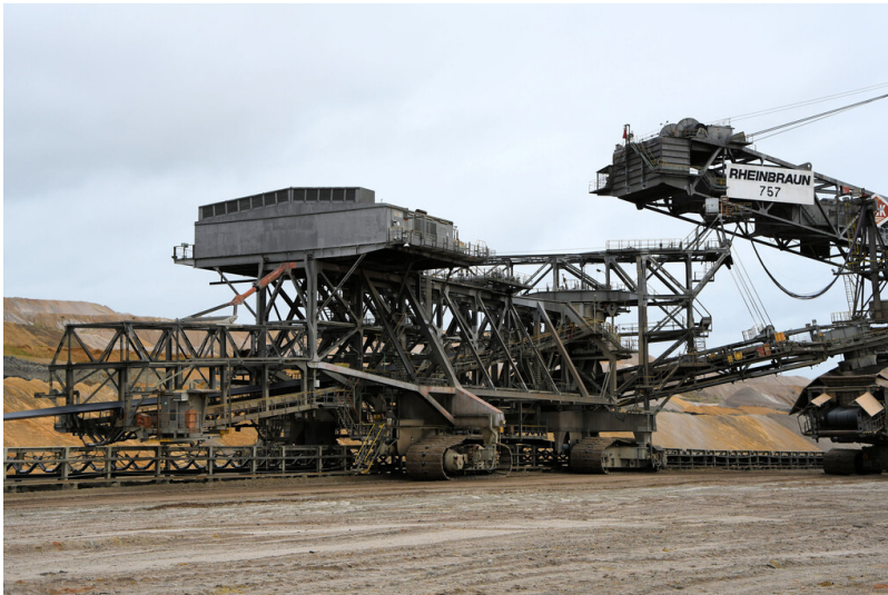
Tagebau Hambach: Bandschleifenwagen 950 mit Auflaufteil und Schwenkbandausleger; Foto: 07.11.2022 Fotograf/Urheber: Dr. Norbert Gilson
