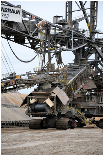
Tagebau Hambach: Absetzer 757, auf Raupenwagen abgestützter Zubringerausleger und Übergabevorrichtung von Bandschleifenwagen 950; Foto: 07.11.2022 Fotograf/Urheber: Dr. Norbert Gilson
