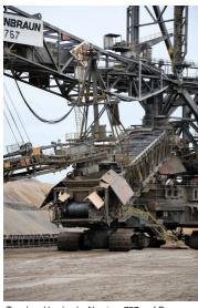
Tagebau Hambach: Absetzer 757, auf Raupenwagen abgestützter Zubringerausleger und Übergabevorrichtung von Bandschleifenwagen 950; Foto: 07.11.2022 Fotograf/Urheber: Dr. Norbert Gilson
