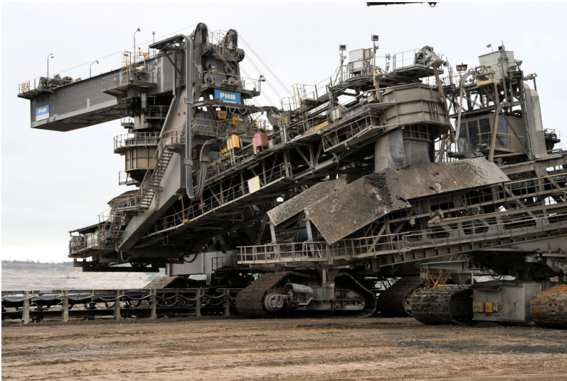
Tagebau Hambach: Bandschleifenwagen 946, Übergabevorrichtung zum Zubringerband des Absetzers 756; Foto: 07.11.2022 Fotograf/Urheber: Dr. Norbert Gilson
