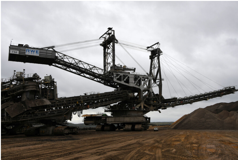
Tagebau Hambach: Absetzer 756 mit 100 m langem Abwurfausleger; Foto: 07.11.2022 Fotograf/Urheber: Dr. Norbert Gilson
