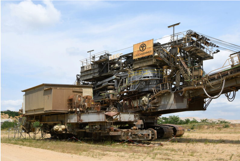
Tagebau Hambach: Bandschleifenwagen 931 (außer Betrieb); Foto: 26.06.2023 Fotograf/Urheber: Dr. Norbert Gilson
