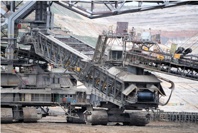
Tagebau Hambach: Absetzer 739, auf Raupenwagen abgestützter Zubringerausleger und Übergabevorrichtung von Bandschleifenwagen 944; Foto: 07.11.2022 Fotograf/Urheber: Dr. Norbert Gilson
