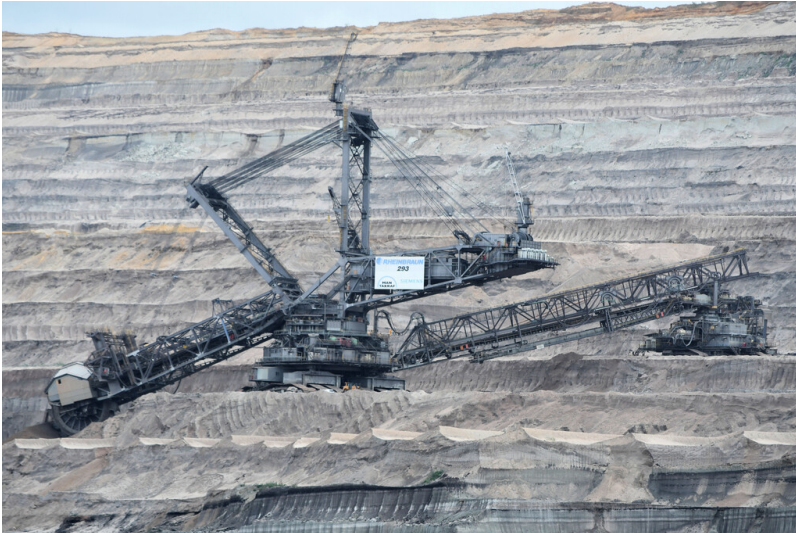
Tagebau Hambach: Schaufelradbagger 293, Schaufelradantrieb (gekapselt) und verfahrbare Verbindungsbandbrücke; Foto: 07.11.2022 Fotograf/Urheber: Dr. Norbert Gilson
