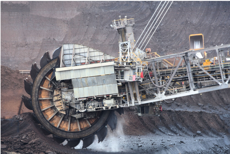
Tagebau Hambach: Schaufelradbagger 289, Schaufelrad mit Antriebsvorrichtung; Foto: 07.11.2022 Fotograf/Urheber: Dr. Norbert Gilson
