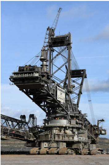
Tagebau Hambach: Schaufelradbagger 287; Foto: 07.11.2022 Fotograf/Urheber: Dr. Norbert Gilson
