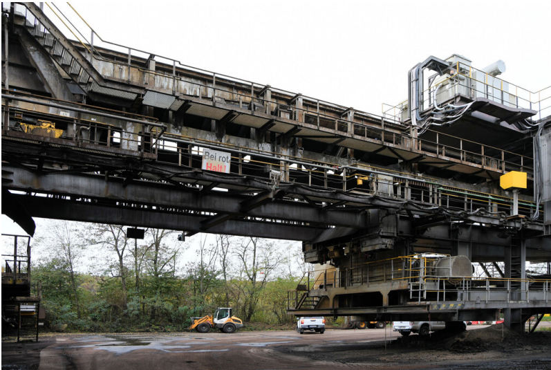
Tagebau Garzweiler: Bandsammelpunkt Kohlebunker Ost, Verschiebekopf des Direktförderbandes vom Bandsammelpunkt Kohlebunker West, Ansicht von Norden; Foto: 03.11.2022 Fotograf/Urheber: Dr. Norbert Gilson
