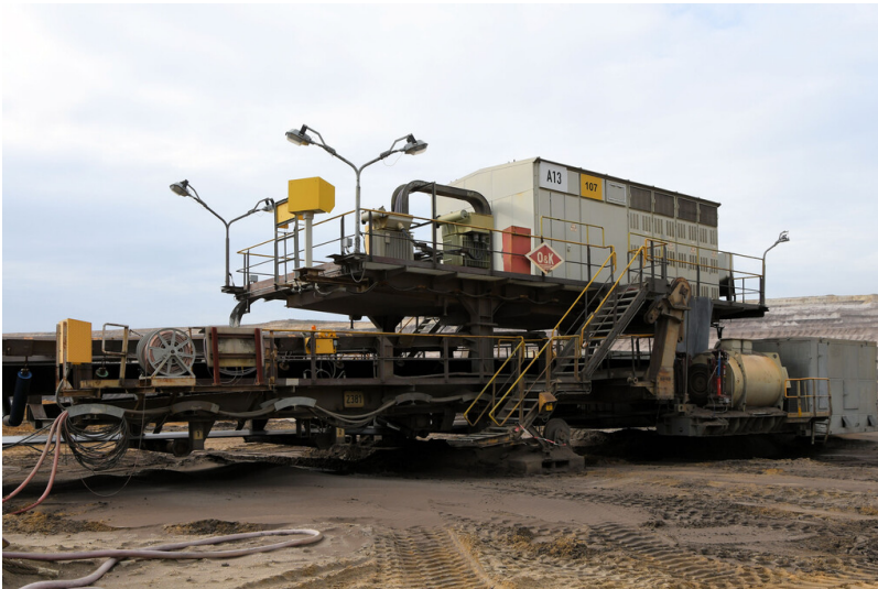
Tagebau Garzweiler: Bandumkehre B 2800 am Ende von Kippstrosse 1; Foto: 03.11.2022 Fotograf/Urheber: Dr. Norbert Gilson
