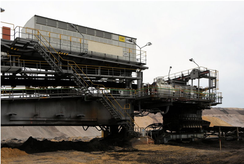
Tagebau Garzweiler: Bandantriebsstation 4 x 1.500 kW (Bandanlage 2200), Aufgabeschurre auf das abgehende Band; Foto: 03.11.2022 Fotograf/Urheber: Dr. Norbert Gilson
