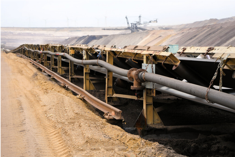
Tagebau Garzweiler: Bandanlage B 2200 aus Girlandenträgergerüsten mit Rückschiene auf der 6. Sohle; Foto: 03.11.2022 Fotograf/Urheber: Dr. Norbert Gilson
