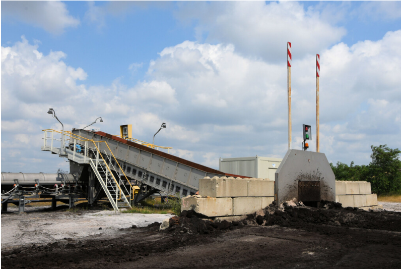
Tagebau Garzweiler: Kohlekonditionierungsanlage, Aufgabevorrichtung auf die Bandanlage Richtung Verschiebekopf, Ansicht von Südosten; Foto: 26.06.2023 Fotograf/Urheber: Dr. Norbert Gilson
