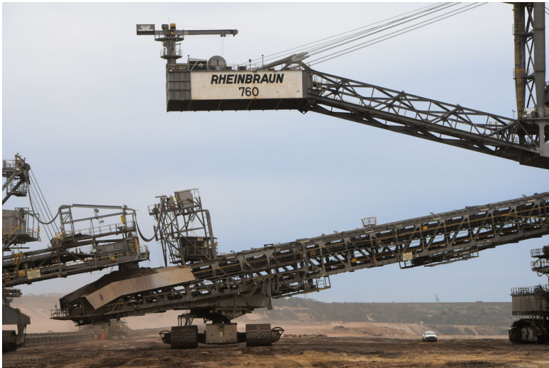
Tagebau Garzweiler: Übergabevorrichtung von Bandschleifenwagen 951 auf das Zubringerband von Absetzer 760; Foto: 03.11.2022 Fotograf/Urheber: Dr. Norbert Gilson
