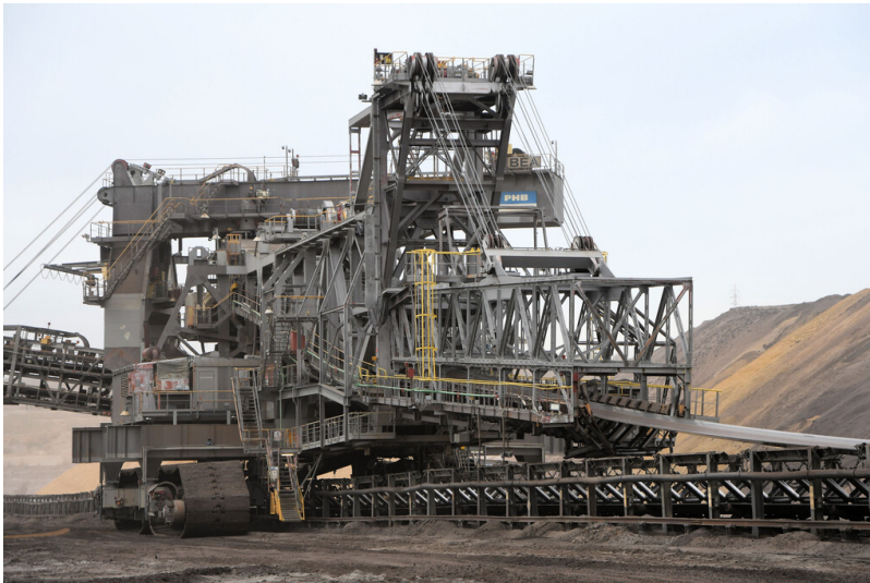
Tagebau Garzweiler: Bandschleifenwagen 945, Auflaufteil; Foto: 03.11.2022 Fotograf/Urheber: Dr. Norbert Gilson
