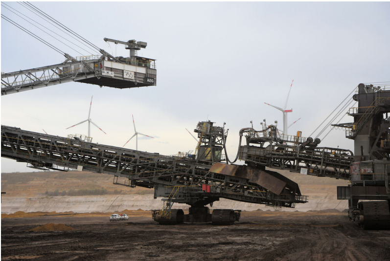
Tagebau Garzweiler: Raupenwagen und Übergabevorrichtung vom Bandschleifenwagenausleger auf das Zubringerband von Absetzer 755; Foto: 03.11.2022 Fotograf/Urheber: Dr. Norbert Gilson
