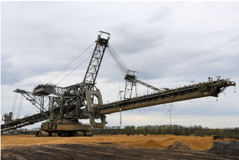
Tagebau Garzweiler: Absetzer 750 mit Rohrausleger; Foto: 03.11.2022 Fotograf/Urheber: Dr. Norbert Gilson
