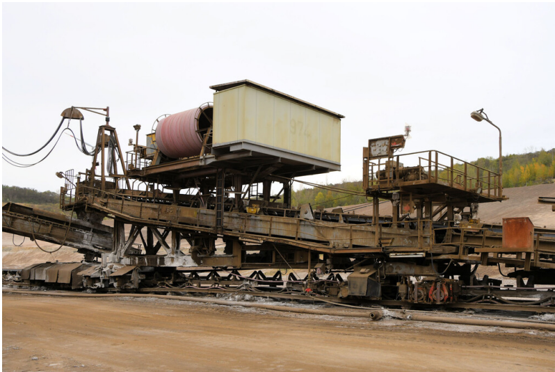
Tagebau Garzweiler: Bandschleifenwagen 974 auf Schienen in der Aschedeponie; Foto: 03.11.2022 Fotograf/Urheber: Dr. Norbert Gilson
