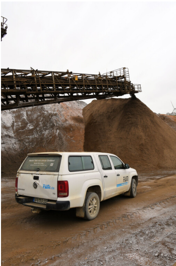
Tagebau Garzweiler: Abwurfausleger von Absetzer 745; Foto: 03.11.2022 Fotograf/Urheber: Dr. Norbert Gilson
