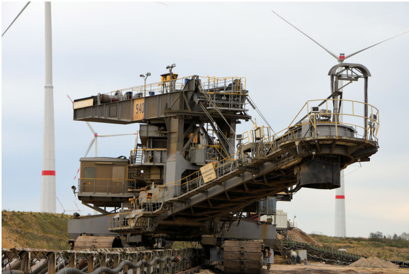
Tagebau Garzweiler: Bandschleifenwagen 940, Schwenkbandübergabeausleger; Foto: 03.11.2022 Fotograf/Urheber: Dr. Norbert Gilson
