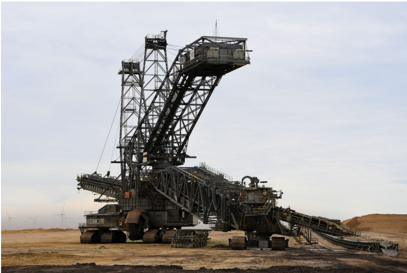
Tagebau Garzweiler: Absetzer 743 mit Raupenwagen zur Abstützung des Zubringerauslegers; Foto: 03.11.2022 Fotograf/Urheber: Dr. Norbert Gilson
