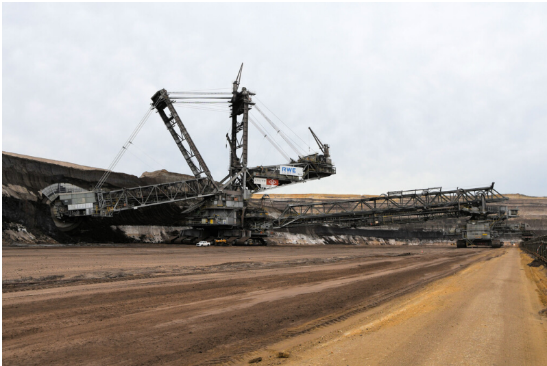
Tagebau Garzweiler: Schaufelradbagger 285 mit Verbindungsbandbrücke und Beladewagen; Foto: 03.11.2022 Fotograf/Urheber: Dr. Norbert Gilson
