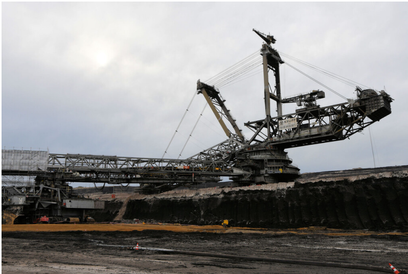
Tagebau Garzweiler: Schaufelradbagger 284 mit Beladewagen unterhalb der Baggerfahrsohle; Foto: 03.11.2022 Fotograf/Urheber: Dr. Norbert Gilson
