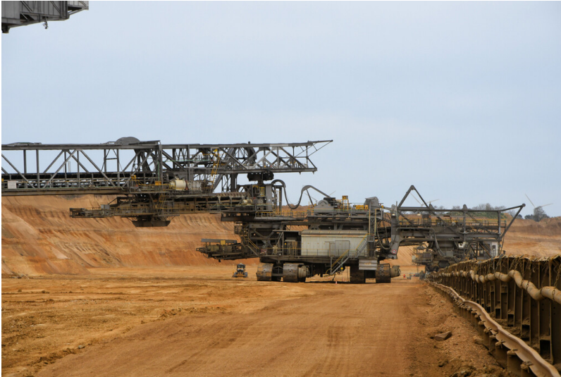
Tagebau Garzweiler: Bandbeladewagen von Bagger 261 mit Übergabevorrichtung von der Verbindungsbandbrücke; Foto: 03.11.2022 Fotograf/Urheber: Dr. Norbert Gilson
