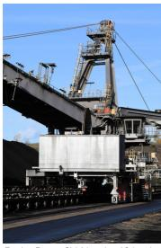
Tagebau Fortuna: Gleisfahrwerk und Schwenkwerk mit Seilstützpylon des Aufnahmegeräts 815, Ansicht von Südosten; Foto: 09.11.2022 Fotograf/Urheber: Dr. Norbert Gilson
