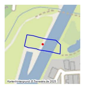
Als Emscher-Düker wurde der Durchlass der Emscher unter dem Rhein-Herne-Kanal bezeichnet. Das Bauwerk wurde in einer Vorläuferversion mit dem Bau des Kanals (bis 1914). In seiner letzten Form wurde der Durchlass 1929 fertig gestellt und führte die Emscher in drei Betonröhren mit jeweils 5,34 Metern Durchmesser unter dem Rhein-Herne-Kanal hindurch. Es handelte sich um eines der größten Bauwerke dieser Art im Emschergebiet und kann als Zeugnis der zeitgenössischen Wasserbaukunst gewertet werden.
