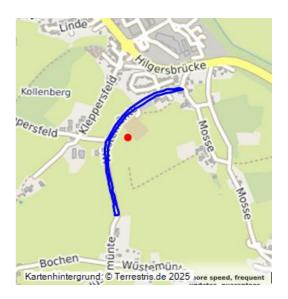
Bereits auf der Preußischen Uraufnahme sind Böschungen beidseits der Wegeverbindung von Wüstemünte nach Hilgersbrücke eingezeichnet. In diesem Bereich führt der Weg vom Wuppertal hinauf auf einen Höhenrücken, weshalb sich hier der Weg unter der mechanischen Beanspruchung durch Fuhrwerke sowie die erodierende Wirkung des Regens auf den Untergrund in das Gelände eingetieft hat.
