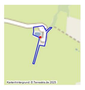
Die Lambecker Mühle liegt an der Lambecke. Das Wasser wurde aus Richtung Milspe in einem langen, fast horizontalen Graben herangeführt und in einem Teich gestaut. Von hieraus lief das Wasser senkrecht zum Mühlhaus und trieb ein unterschlächtiges Mühlrad an.
